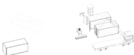
1. Aménagement du site de chantier avec conteneurs comprenant matériaux, outils et bureautique
